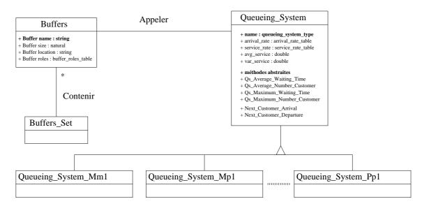
Fig. 7.6 – Diagramme UML des classes concernant les tampons dans Cheddar
