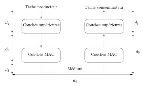
Fig. 2.13 – Décomposition du délai de communication
