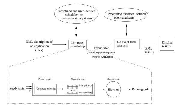
Fig. 7.4 – Fonctionnement d'un ordonnanceur dans Cheddar
