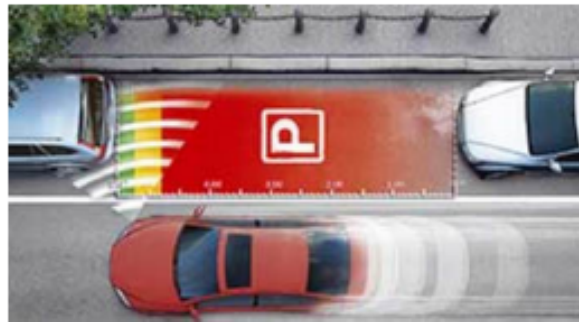
Fig. 3.8 Assistance au stationnement avec capteur ultrason à droite
