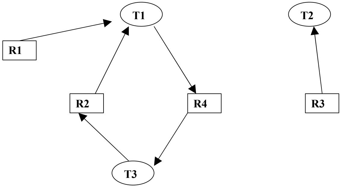
Dans ce schéma, on se retrouve avec un cycle entre T1, T3, R2 et R4, il n'y a aucun moyen de sortir de ce cycle : on est en présence d'un interblocage.
