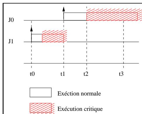
FIG. 3.5 – Inter-blocage avec PIP
