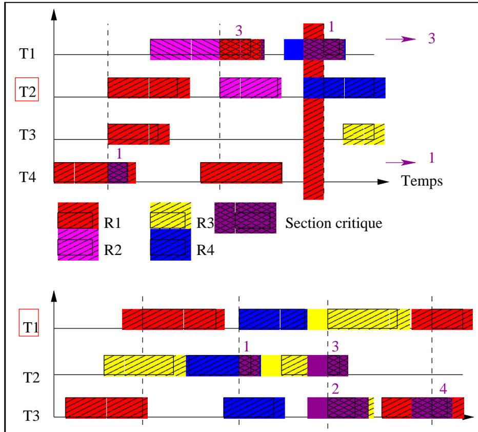
FIG. 3.6 – Temps de blocage avec PIP
