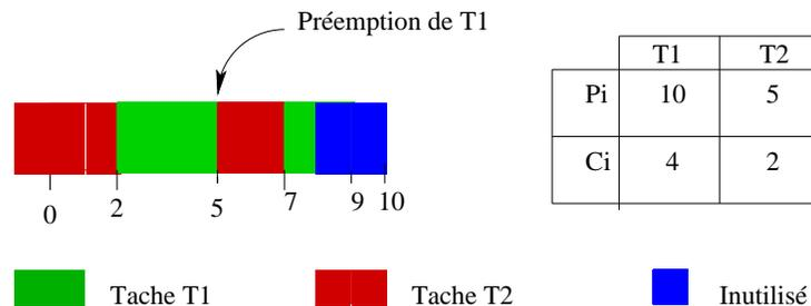
FIG. 2.3 – Exemple de l'algorithme RM
