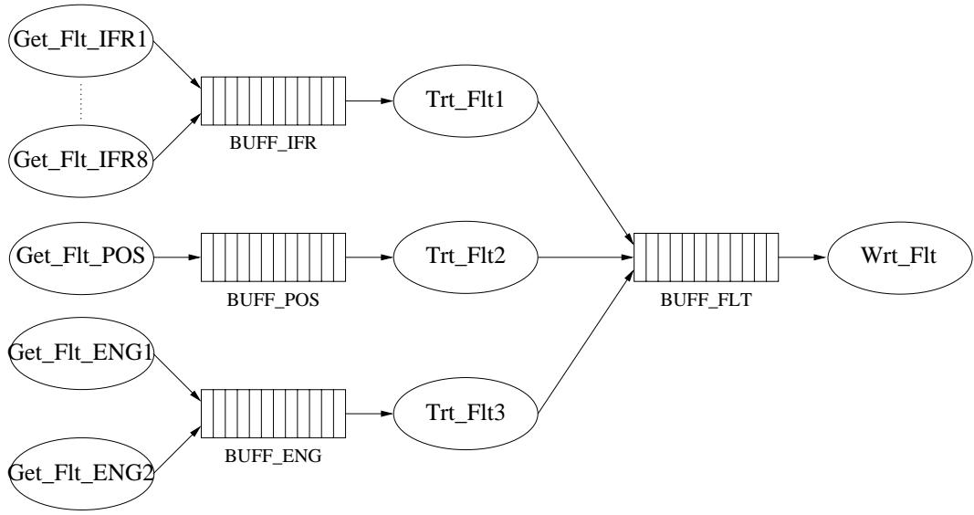
FIG. 9 – Tâches, tampons et flot des données
