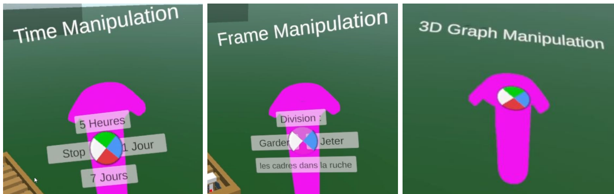
FIGURE 7.5 – Manette vue par l'utilisateur, respectivement en modes Temps, Cadre et Visualisation. On observe le bouton principal divisé en quatre cadrans, transformant ce bouton unique en quatre boutons "virtuels".
